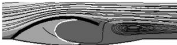
Рис. 2. Расчетная зона агрегации в модели венозного клапана в момент минимального расхода
